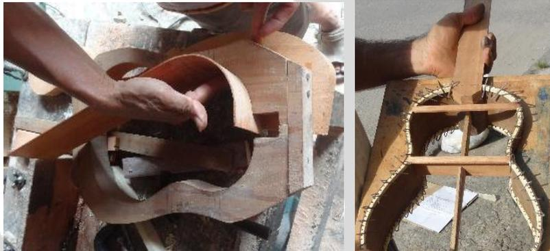
Es importante que en este proceso se tense internamente a presión los aros con varas de madera contra el molde para que no pierda la forma en ningún sentido, en este paso también se pegan los cerquillos postes, puentes, y prensarlos con ganchos o pinzas, el mástil se debe ensamblar en la parte superior como corresponde y encaja en el molde.
