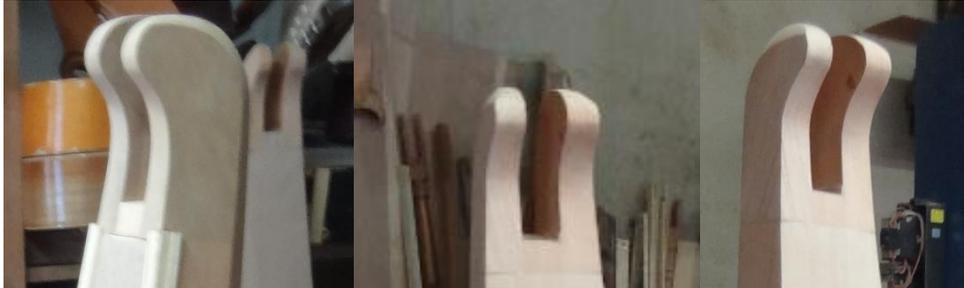
Para el armado de la cabeza se pone el descanso donde encaja el diapasón en medio de las dos láminas, se pega y se prensa de forma que quede un espacio preciso para que entre el diapasón.
